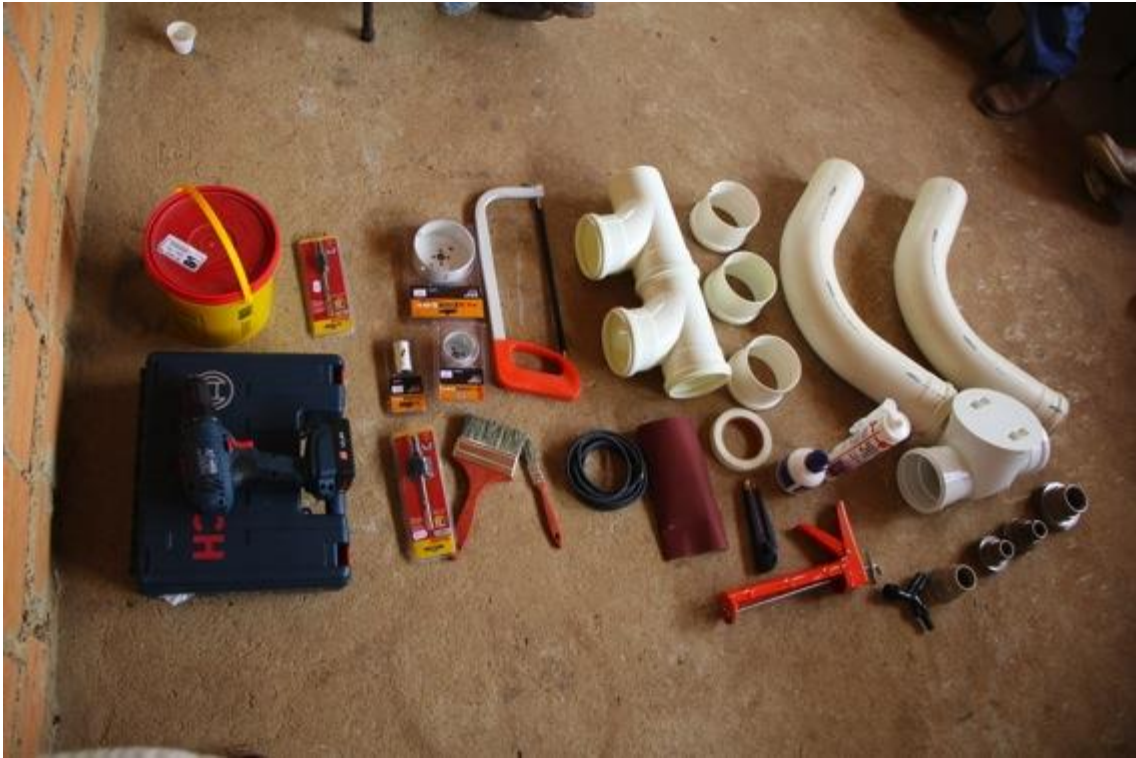
materiais, conexões e ferramentas necessárias para construção da fossa biodigestora
