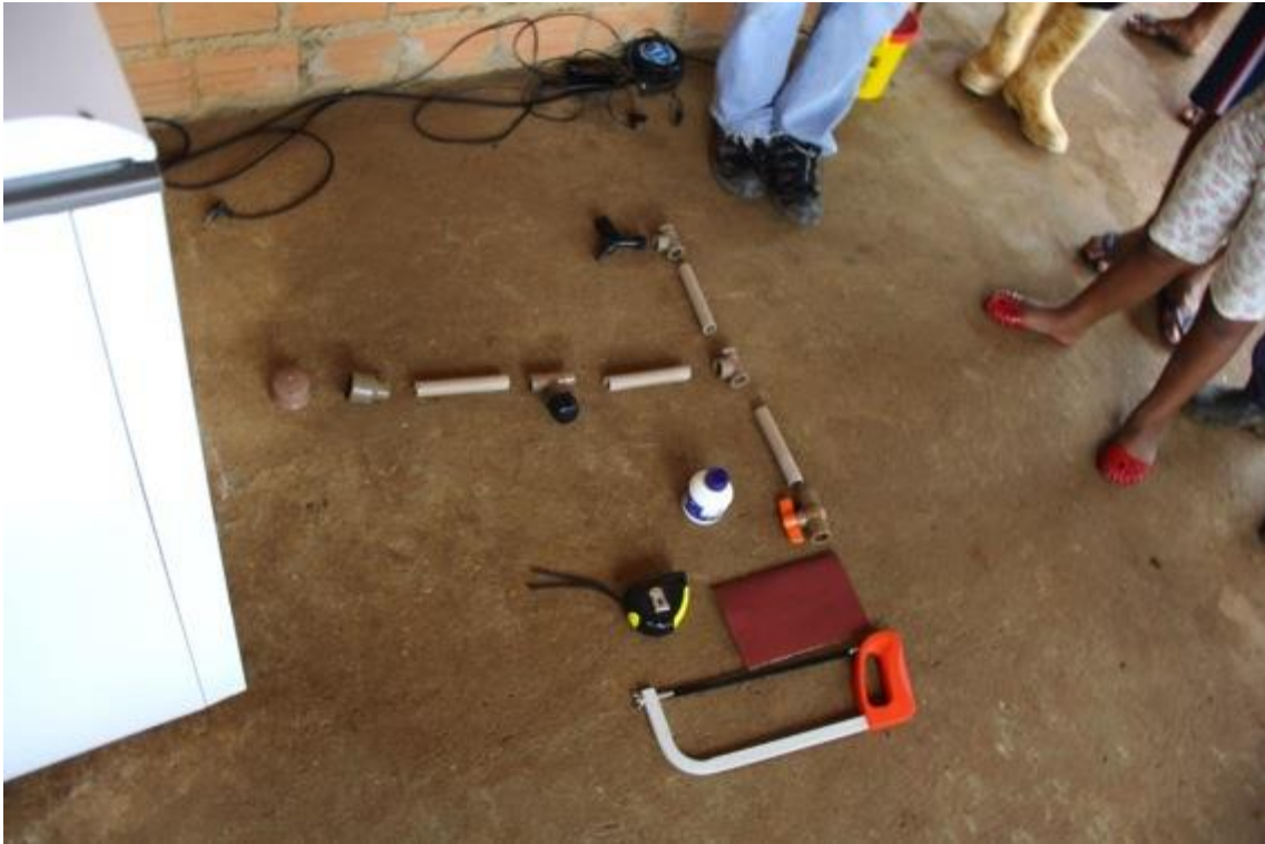
materiais necessários para produção do clorador
