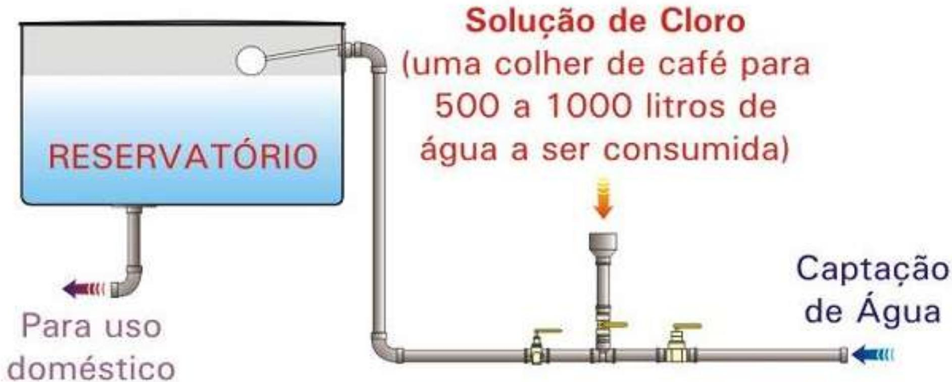
Instalação do Clorador Embrapa na rede de captação de água.
